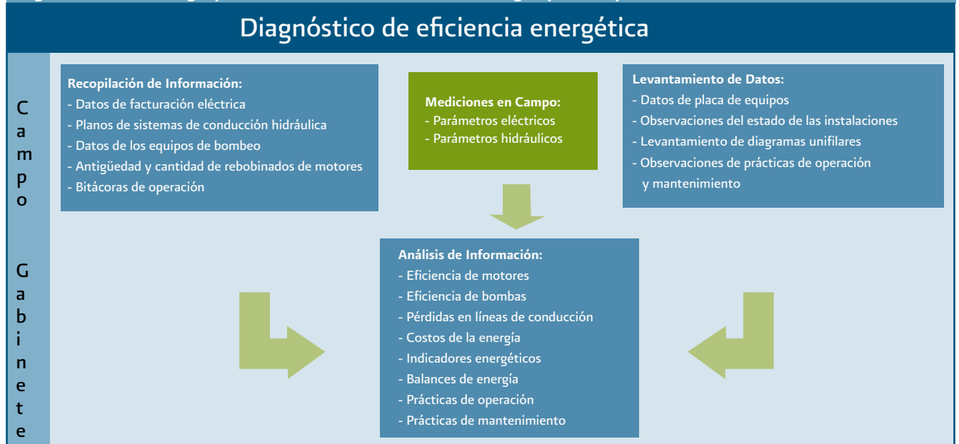
Figura 4.2 Metodología para realizar un DEE en sistemas de agua potable y saneamiento
