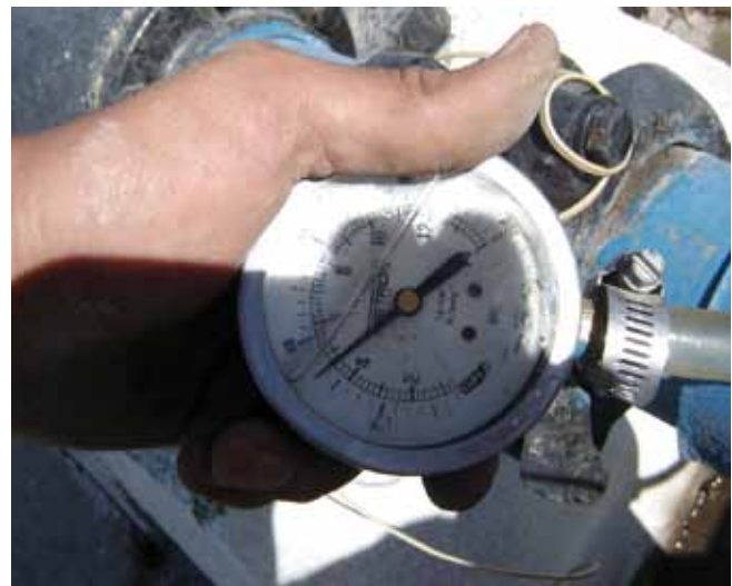
Figura 1.18 Medición de presión con manómetro tipo Bourdon calibrado
