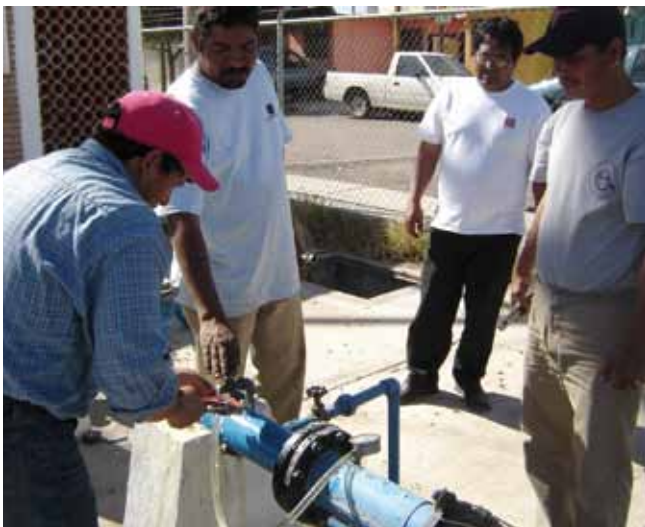
Figura 1.18 Medición de presión con manómetro tipo Bourdon calibrado
