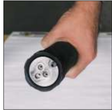
▲Cabeza fresadora Bridge Blaster. El sistema Bridge Blaster se puede configurar con una cabeza expulsora radial, un anillo flotante y una fresa Reed-Hycalog (izquierda), o bien con boquillas de chorro abrasivo orientadas hacia abajo (derecha), que perforan un hoyo en los puentes de incrustaciones que no se pueden cortar con una fresa de carburo de tungsteno.
