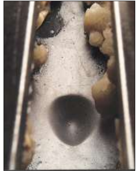
▲ Eliminación de incrustaciones de carbonato de calcio con chorro de agua abrasivo. La tubería recibió un solo chorro de agua con arena abrasiva a razón de 2,4 pulg./min [1 mm/seg]. Durante el ensayo se mantuvo el chorro en la misma posición durante 3 minutos, y el chorro de arena penetró casi el 80% de la pared del tubo (nivel de daño inaceptable).
