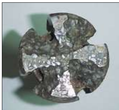
▲ Cabeza pulidora gastada por el polvo de sílice.
