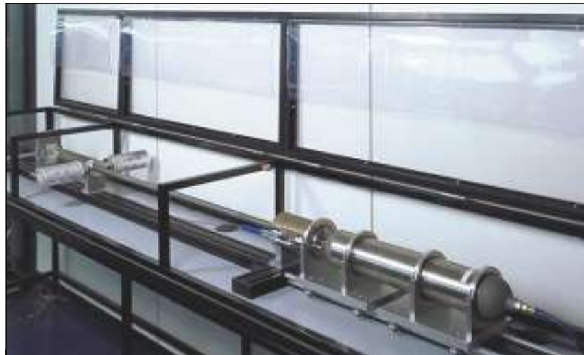
▲ Eliminación de incrustaciones de carbonato de calcio con chorro de agua abrasivo. La tubería recibió un solo chorro de agua con arena abrasiva a razón de 2,4 pulg./min [1 mm/seg]. Durante el ensayo se mantuvo el chorro en la misma posición durante 3 minutos, y el chorro de arena penetró casi el 80% de la pared del tubo (nivel de daño inaceptable).
