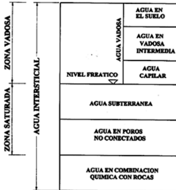
Figura 2.3 Esquema de la distribución de agua subterránea en el perfil del subsuelo
