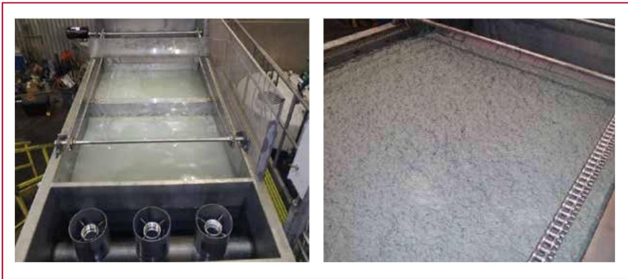
Ilustración 1.29 Sistemas de flotación por aire disuelto
