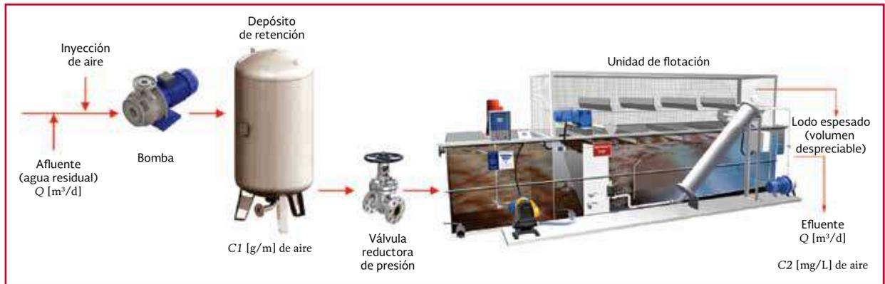
Ilustración 1.27 Variaciones al sistema DAF con recirculación
