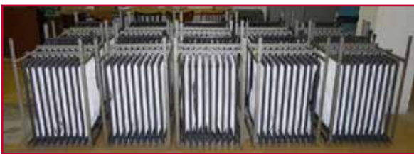
Ilustración 3.30 Módulos de membranas de fibra hueca.
