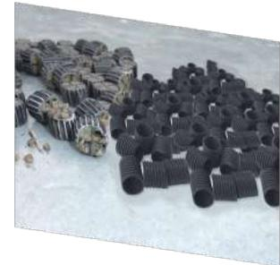
**Este empaque, sirve de soporte para la adhesión de microorganismos, se mantiene en suspensión en el licor mezclado, por lo cual se mueve en conjunto con él en todo el volumen de aireación**
