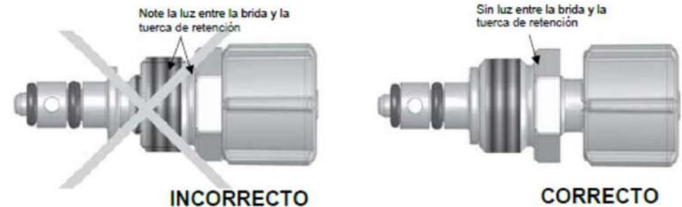
Figura 30: Posición del O-ring de la válvula FastPrime™
