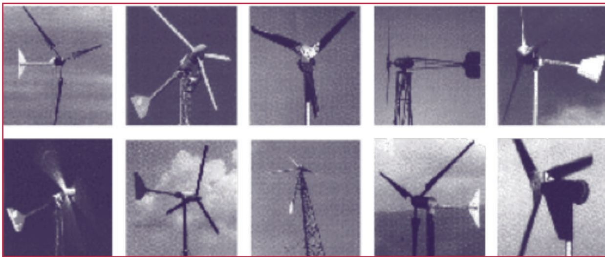
Ilustración 2.39 El sistema de orientación de casi todos los aerogeneradores pequeños es por veleta de cola
